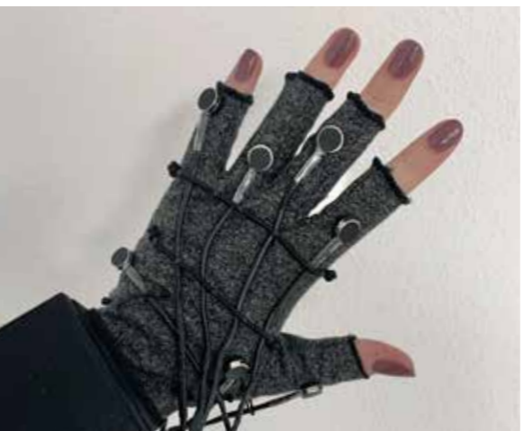
Prototyp: Vibrationshandschuh zur Vermittlung taktiler Reize (Foto: A. Kushnir)
